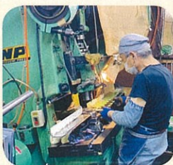
②板を丸く切り抜く作業
